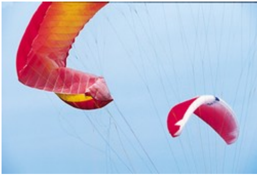
Podczas krawata wkręca się końcówka pod glajta i klinuje pomiędzy linkami.
